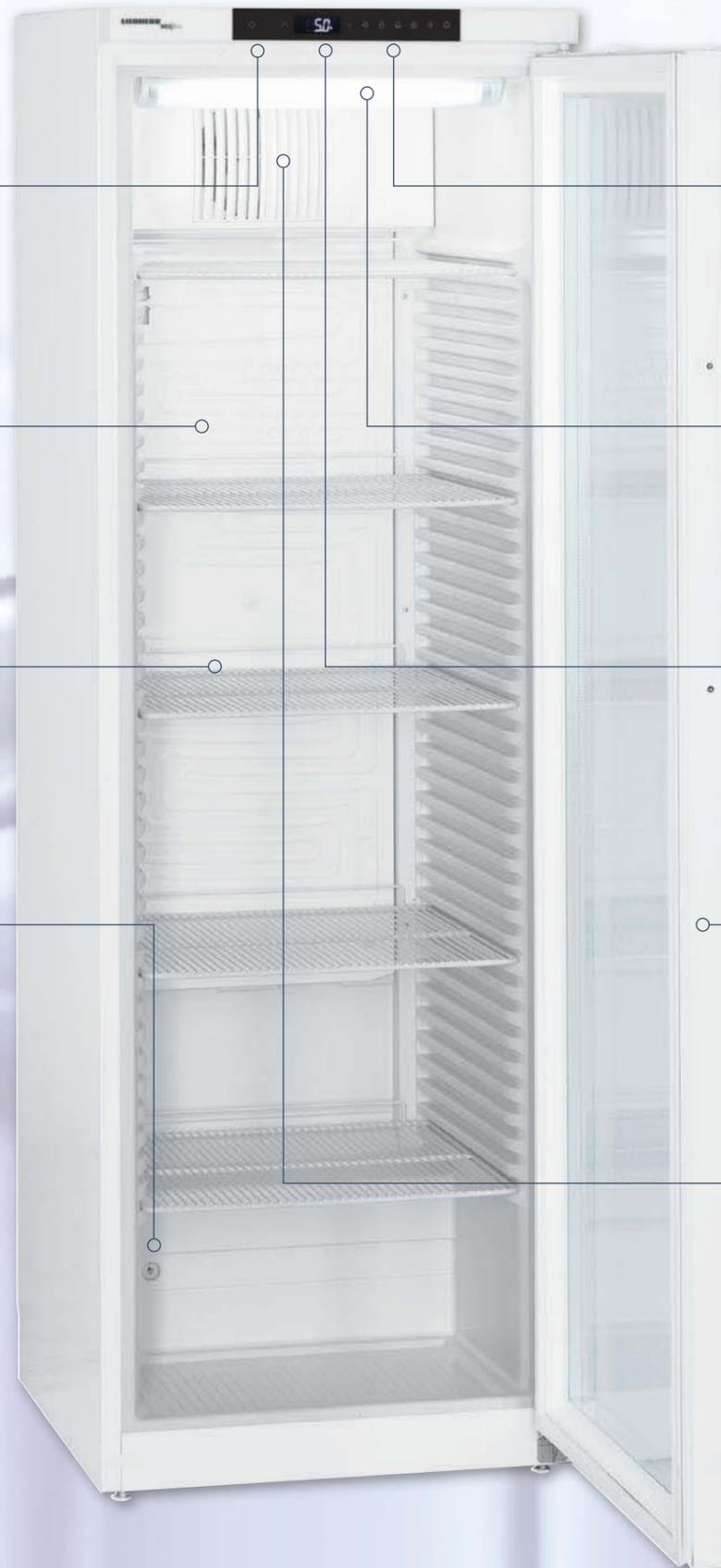
Die **präzise Elektronik** mit digitaler Temperaturanzeige erlaubt eine genaue Temperatureinstellung. Ein **integrierter Datenspeicher** dokumentiert die jeweils letzten drei Temperaturalarm- und Netzausfallereignisse mit Datum, Uhrzeit und Dauer des Alarms. Die entsprechenden Daten können über die AlarmLog-Funktion abgerufen und auf dem Displayfeld abgelesen werden.
