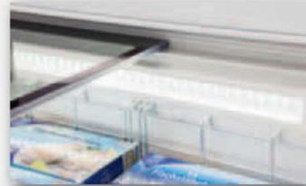
**Schiebedeckel.** Die leicht zu bewegendem Schiebedeckel aus Einscheiben-Sicherheitsglas mit ihren speziellen Dicht- und Gleitprofilen schließen besonders dicht, verhindern Kälteverlust und unterstützen die gute Energieeffizienz der Geräte.
