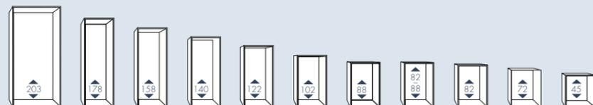
Le misure di nicchia fanno riferimento agli standard delle nicchie dei mobili (in profondità e in larghezza). Le misure di nicchia sono indicative delle dimensioni e dell'altezza delle apparecchiature. Le misure esatte delle apparecchiature sono riportate negli schemi per l'incasso.
