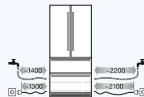
Inklusive 3m Panzerschlauch für Festwasseranschluss 3/4"
