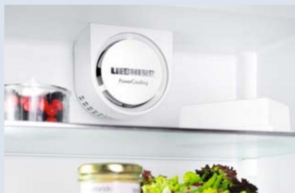
Le système **PowerCooling** performant veille à un refroidissement rapide des produits frais stockés et à une température de réfrigération homogène dans tout l'espace intérieur. Un interrupteur avec contact de porte stoppe le ventilateur lors de l'ouverture de la porte. Cette astuce permet de faire de grosses économies d'énergie.
