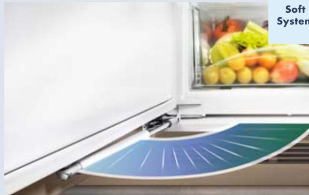
Le **SoftSystem** intégré dans la porte dans un blanc noble amortit le mouvement lors de la fermeture de la porte et garantit même une fermeture particulièrement douce en cas de chargement complet de la porte intérieure. Dès un angle d'ouverture d'env. 30°, la porte se referme automatiquement.
