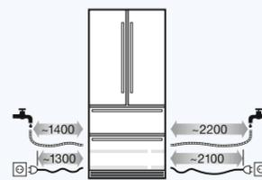
Tuyau flexible blindé longueur 3 mètres pour appareils avec prise d'eau fixe 3/4" inclus
