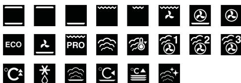
Natürliche Konvektion, Oberhitze, Unterhitze, Einfach- und Doppelgrill, Belüfteter Grill, Heissluft und Unterhitze, Heissluft, ECO-Heissluft, Belüftete Unterhitze, Bratautomatik, Dampf/auf Grad genau, Heissluft und Dampf, Vorwärmen, Auftauen, Regeneration, Tellerwärmer, Warmhalten, SteamClean-Dampfreinigung
