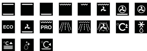
Natürliche Konvektion, Oberhitze, Unterhitze, Einfach- und Doppelgrill, Belüfteter Grill, Heissluft und Unterhitze, Heissluft, ECO-Heissluft, Belüftete Unterhitze, Bratautomatik, Mikrowelle, Mikrowelle und Grill, Heissluft und Mikrowelle, Vorwärmen, Auftauen, Tellerwärmer, AquaClean-Reinigung, Warmhalten
