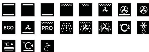
Natürliche Konvektion, Oberhitze, Unterhitze, Einfach- und Doppelgrill, Belüfteter Grill, Heissluft und Unterhitze, Heissluft, ECO-Heissluft, Belüftete Unterhitze, Bratautomatik, Mikrowelle, Belüftete Mikrowelle und Grill, Heissluft und Mikrowelle, Vorwärmen, Auftauen, Tellerwärmer, Warmhalten, AquaClean-Reinigung
