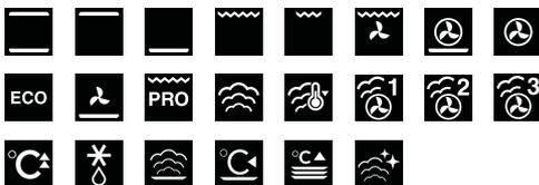
Natürliche Konvektion, Oberhitze, Unterhitze, Einfach- und Doppelgrill, Belüfteter Grill, Heissluft und Unterhitze, Heissluft, ECO-Heissluft, Belüftete Unterhitze, Bratautomatik, Dampf/auf Grad genau, Heissluft und Dampf, Vorwärmen, Auftauen, Regeneration, Tellerwärmer, Warmhalten, Dampfreinigung
