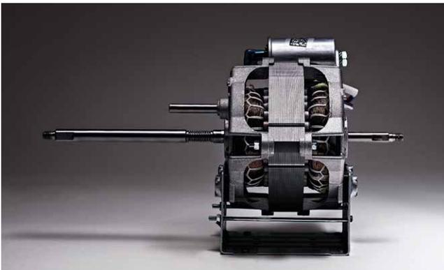
Unsere Waschmaschinen sind mit einem Induktionsmotor ausgestattet, der einen optimalen mechanischen Widerstand bietet und das Schleudern bei sehr hoher Geschwindigkeit regelt. Dieser bürstenlose Motor erweist sich als besonders leise, zuverlässig und wirtschaftlich.
