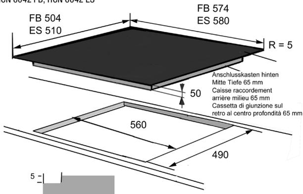
FB Ausfräsung/fraisage/fresatura 510 x 580 mm R = 8 mm
