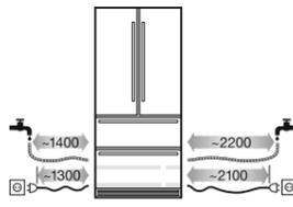
Festwasseranschluss für automatischen Eiswürfelbereiter notwendig (3/4")!
