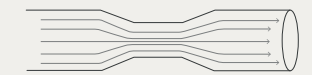
Rappresentazione di un restringimento del condotto attraverso cui transita il flusso d'aria.
