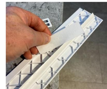
Retirez le filtre et nettoyez-le avec un détergent doux, rincez-le à l'eau courante. Remplacez-le et fermez le porte-filtre.
