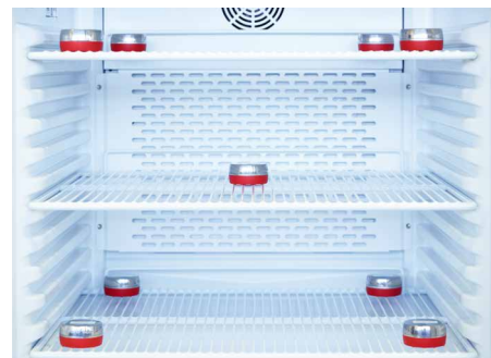
Kundenspezifische 9 Punkt-Kalibrierung Etalonnage spécifique au client avec sonde 9 points
