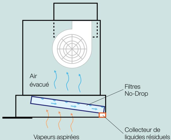
L'inclinaison légère des filtres permet aux vapeurs condensées d'être collectées dans un réceptacle facile à retirer et à nettoyer.
