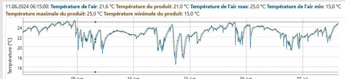
La température de l'air mesurée est trop élevée : Température de l'air mesurée : 25,2 °C ; Seuil de température de l'air : 25 °C
