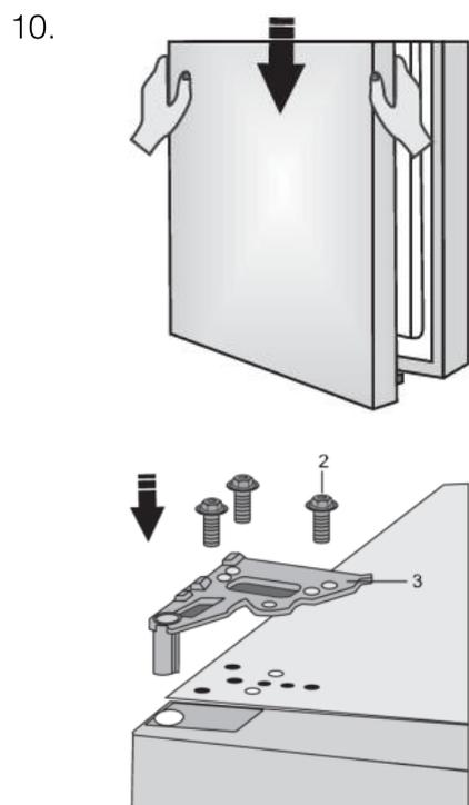
Posizionare lo sportello sulla cerniera inferiore e utilizzare le viti (2) per fissare la cerniera superiore (3). Tenere lo sportello in posizione durante il montaggio.
