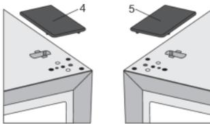
Rimuovere il cappuccio di copertura (destro) (4) dalla busta e posizionarlo sul punto in cui è stato rimosso il cardine superiore. Rimuovere e conservare il cappuccio di copertura dall'altro lato (5) in cui verrà collocato il cardine.
