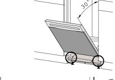
La porte s'abaisse : Fermez la porte, serrez légèrement les vis et vérifiez à nouveau le réglage.
