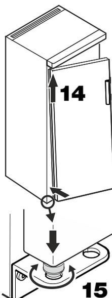
18. Schrauben lösen und Scharnierwinkel nach rechts oder links verschieben. Schrauben festziehen.
