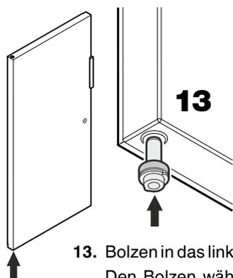
13. Bolzen in das linke Lager der Tür einsetzen.
