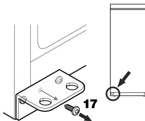
17. Mittlere Schraube vom Scharnierwinkel herausdrehen.
