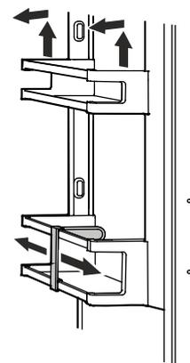
En modifiant la position de la **cloison de maintien bouteilles**, vous évitez que les bouteilles ne se renversent à l'ouverture et à la fermeture de la porte.
