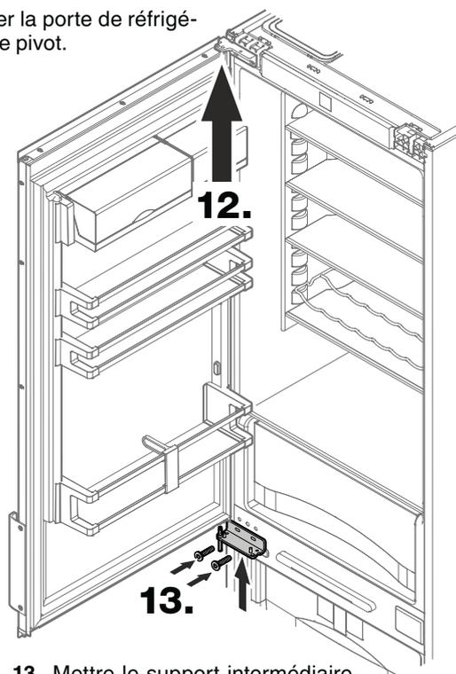
13. Mettre le support intermédiaire en place dans la porte et le visser sur l'appareil.
