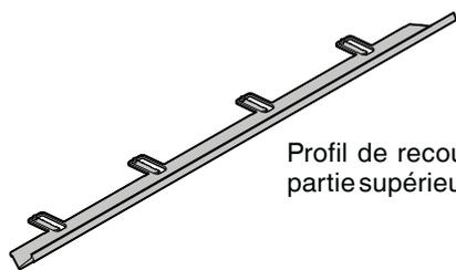
Profil de recouvrement (du jeu entre la partie supérieure de l'appareil et la niche)
