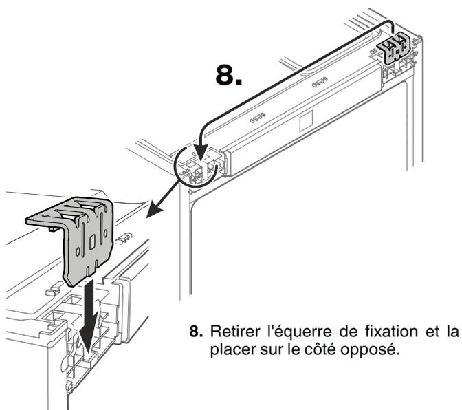
8. Retirer l'équerre de fixation et la placer sur le côté opposé.
