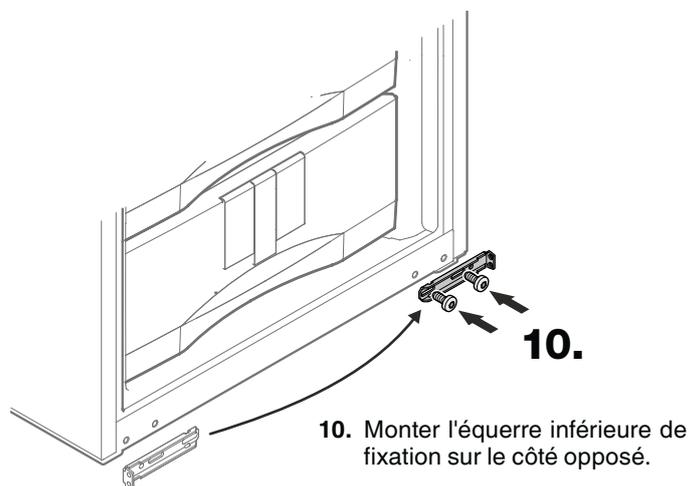
10. Monter l'équerre inférieure de fixation sur le côté opposé.
