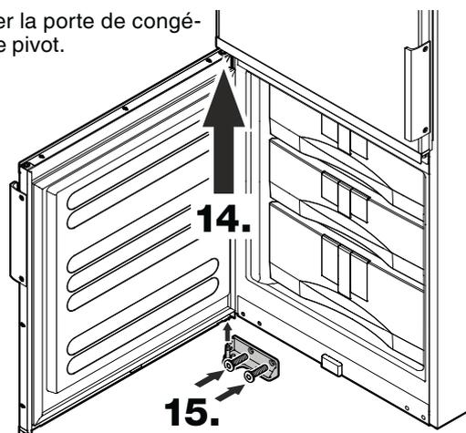
15. Mettre le support inférieur en place dans la porte et le visser sur l'appareil.
