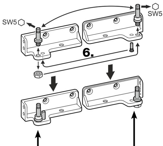
Dieser Scharnierwinkel wird später, wie in Punkt 15 beschrieben, links unten montiert.
