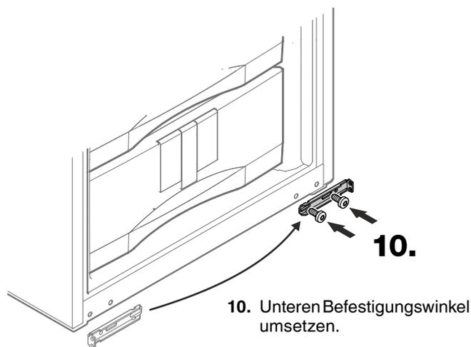
10. Unteren Befestigungswinkel umsetzen.
