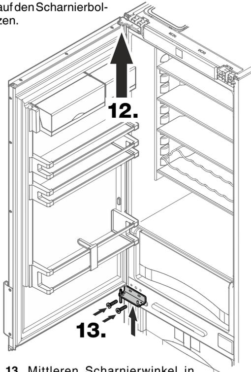
13. Mittleren Scharnierwinkel in die Tür einsetzen und am Gerät anschrauben.
