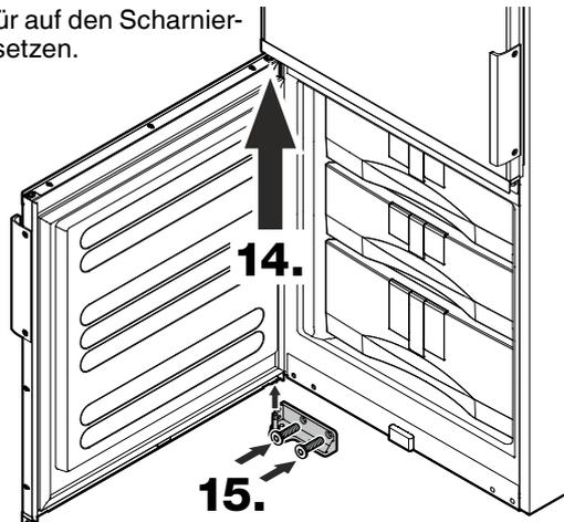
15. Unteren Scharnierwinkel in die Tür einsetzen und am Gerät anschrauben.
