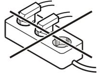
Keine Inselwechselrichter (Umwandeln von Gleichstrom in Wechsel- bzw. Drehstrom) oder Energiesparstecker verwenden. Beschädigungsgefahr für die Elektronik!
