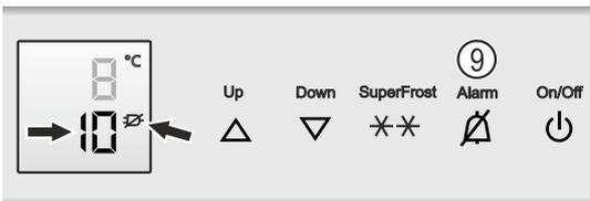
**Alarm-Taste** ⑨ drücken um die Anzeige zu löschen.
