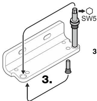
3. Bolzen des mittleren Scharnierwinkels herausschrauben, auf der Gegenseite einschrauben und festziehen.
