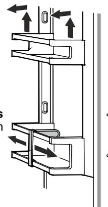
Durch Verschieben des **Flaschenhalters** können Sie Flaschen gegen Umkippen beim Türöffnen und -schließen sichern.
