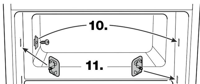
10. Monter le crochet de fermeture sur le côté opposé.
