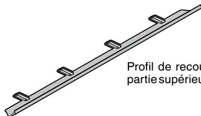
Profil de recouvrement (du jeu entre la partie supérieure de l'appareil et la niche)
