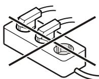
Ne pas utiliser d'onduleurs (conversion du courant continu en courant alternatif ou triphasé) ou de fiches économie d'énergie. Risque d'endommagement du système électronique!
