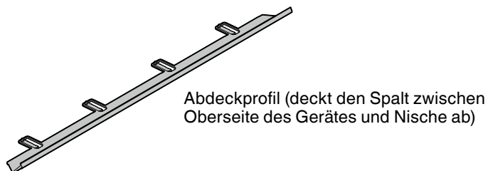
Abdeckungen Montage links oben bei Türanschlag rechts. Montage rechts oben bei Türanschlag links.
