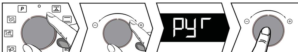
Le programmeur doit afficher l'heure du jour, sans clignoter. Sélectionnez le cycle d'autonettoyage avec la manette de fonctions **P** : choisir votre pyrolyse à l'aide de la manette + et - en fonction du degré de salissure de votre four et validez en appuyant sur la manette.
