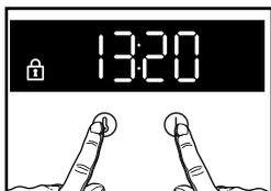
Appuyez simultanément sur les touches  $\oplus$  et  $\ominus$  jusqu'à l'affichage du symbole  $\mathfrak{L}$  à l'écran. Pour le déverrouiller, appuyez simultanément sur les touches  $\oplus$  et  $\ominus$  jusqu'à ce que le symbole  $\mathfrak{L}$  disparaisse de l'écran.
