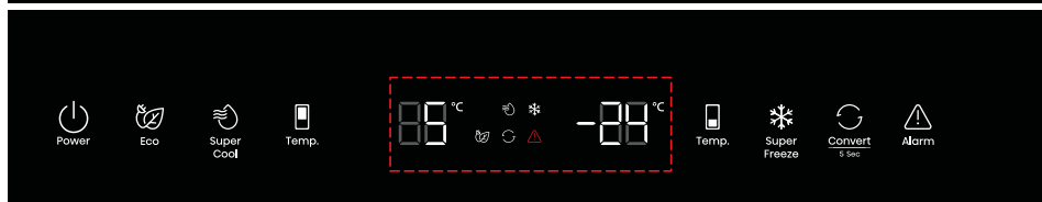
Commande électronique (située en haut de l'appareil) sans fonction Wi-Fi
