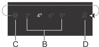
Les chiffres 2, 4, 6 et 8 indiquent la température en degrés Celsius (°C) dans le réfrigérateur.
