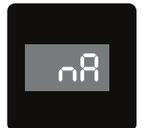
Wenn Sie während der **nA**-Anzeige die "ALARM"-Taste drücken, erscheint in der Anzeige die wärmste Temperatur die sich während des Netzausfalls einstellte. Je nach Erwärmung oder sogar Auftauung sollten Sie die Qualität der Lebensmittel prüfen und die weitere Verwendung entscheiden!
