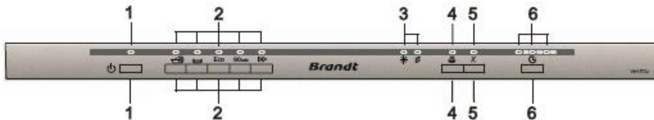
1. Ein-/Aus-Taste und -Anzeige: Zum Ein-/Ausschalten der Stromversorgung. Die Anzeige leuchtet auf, sobald das Gerät unter Spannung steht.
