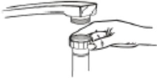
Schließen Sie den Kaltwasserzulaufschlauch an eine 3/4 Rohrverschraubung an und stellen Sie sicher, dass er korrekt fest sitzt.
