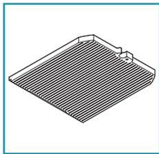
De actieve koolstoffilters dienen om de geurtjes tegen te houden in de luchtstroom die erdoor stroomt: de gezuiverde lucht wordt opnieuw in de keukenruimte vrijgegeven voor volgende passages door de filters.
