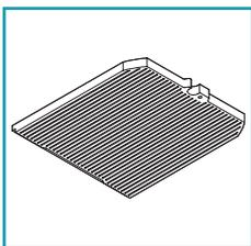
Фильтры с активированным углем предназначены для улавливания запахов, содержащихся в проходящем через них потоке воздуха. Очищенный в результате нескольких проходов через фильтры воздух возвращается в кухню.
