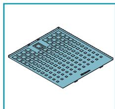
Metallfettfiltrene hvis funksjon er å samle fettpartikler: disse avsettes på filtrene og forsyner eventuelle flammer som sendes ut under koking, de genererer ubehagelig lukt og svekker luftpassasjen ved å redusere sugkapasiteten til ventilatorhetten.
