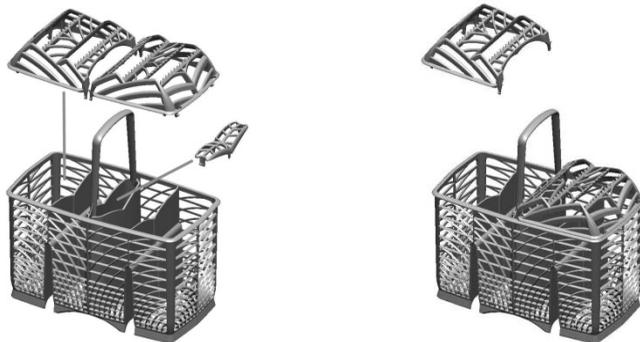
Der Besteckkorb kann quer **an eine beliebige Stelle** verschoben werden, damit man den Platz im Unterkorb möglichst optimal nutzen kann.
