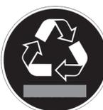
Questo adesivo o uno simile si può trovare sul lato posteriore dell'apparecchiatura. Si riferisce ai pannelli in materiale espanso nella porta e/o nell'apparecchiatura. Questa avvertenza vale solo per il riciclaggio. Non rimuovere gli adesivi.
