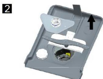
Schritt 2: Filtersatz herausheben
