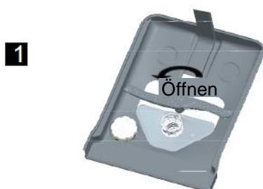
Schritt 1: Filter gegen den Uhrzeigersinn drehen.
