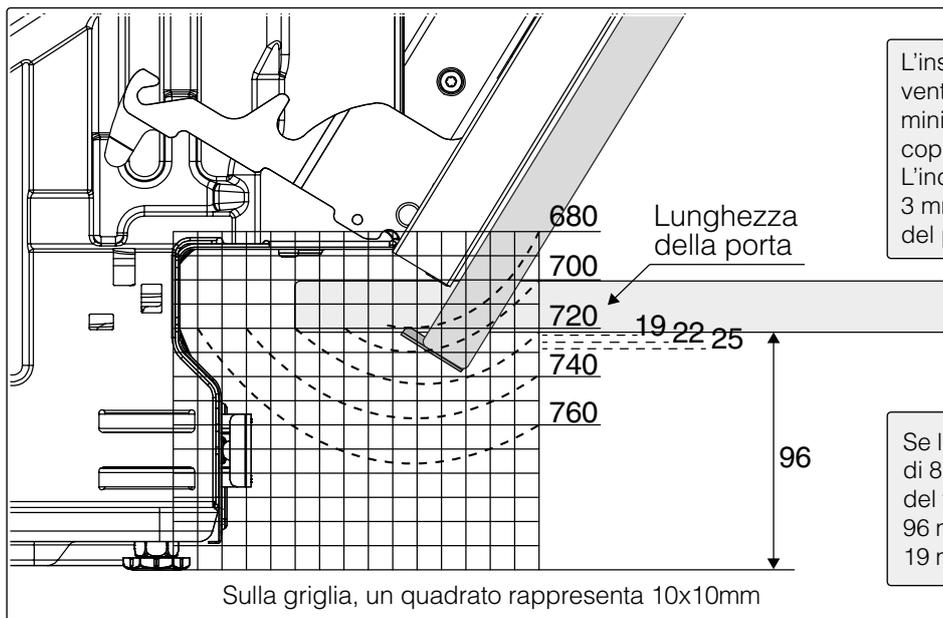
L'installazione della bocchetta di ventilazione richiede uno spazio minimo di 5 mm sotto il pannello coprianta.
