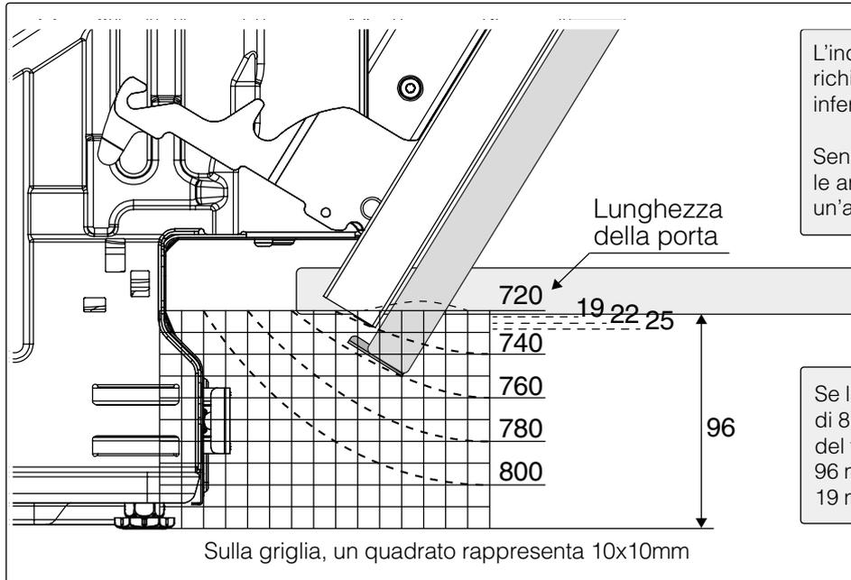
L'indicazione Status Light richiede 3 mm in più sotto il bordo inferiore del pannello coprianta.
