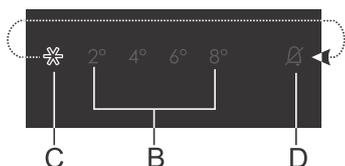
Attivare il congelamento intensivo premendo il tasto **A** più volte fino a quando si illumina il simbolo **C**.
