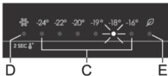
Si la température est trop élevée à l'intérieur de l'appareil, un signal sonore (intermittent) retentit et le voyant en dessous de la température réglée (**C**) se met à clignoter.
