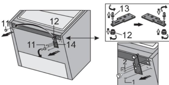
Dévissez les trois vis de la charnière inférieure (14) et retirez-la. Retirez le pied supplémentaire (12) de l'axe de charnière inférieur (13). Dévissez la goupille (13) de la charnière inférieure et vissez-la sur le côté opposé de la charnière, avec le pied supplémentaire (12).
