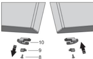
Enlevez la vis (8) puis retirez le rétenteur de porte (10) et la butée (9). Fixez ensuite le rétenteur de porte fourni dans le sachet et la butée (9) avec la vis (8). Conservez le rétenteur de porte (10) au cas où vous en auriez besoin ultérieurement.
