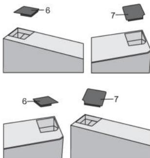
Enlevez le couvercle (6) du côté gauche de la porte. Enlevez ensuite le couvercle (7) du côté droit de la porte. Placez le couvercle (7) sur le côté gauche de la porte et placez le couvercle (6) sur le côté droit de la porte.
