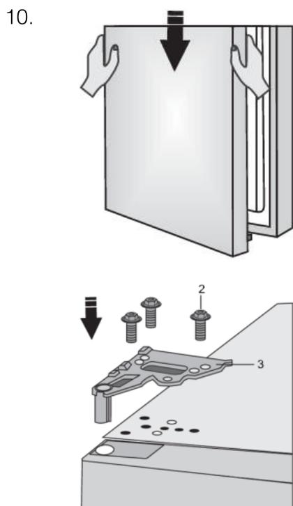
Placez la porte sur la charnière inférieure et utilisez les vis (2) pour fixer la charnière supérieure (3). Maintenez la porte en place tout en la positionnant.
