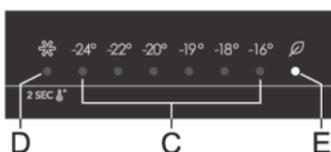
**Mise en marche** : pour activer la fonction **Eco**, appuyez sur la touche **B** plusieurs fois jusqu'à ce que le voyant **E** s'allume. Lorsque cette fonction est activée, l'appareil fonctionne dans des conditions optimales.
