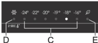
Les chiffres -16, -18, -19, -20, -22 et -24 indiquent la température en degrés Celsius (°C) dans l'appareil.
