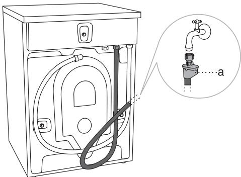
Utilisez le flexible d'alimentation pour brancher l'appareil. La pression de l'eau d'arrivée doit être comprise entre 0,1 and 1 MPa (environ 1–10 kp/cm<sup>2</sup>, 1–10 bar, 10–100 N/cm<sup>2</sup>).
