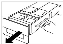
**1** Sur le côté droit de la partie inférieure du récipient doseur, appuyez sur le mécanisme de déverrouillage et retirez complètement ce dernier de son logement.
