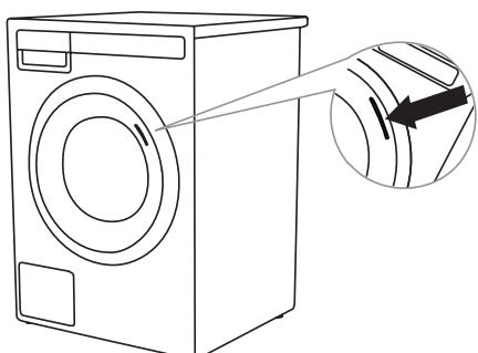
La porte du lave-linge est conçue pour s'ouvrir sur le côté droit, un autocollant placé sur la face avant de la porte indique clairement l'endroit à saisir pour ouvrir la porte.
