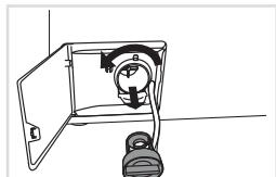
**4** Tournez lentement le filtre dans le sens contraire des aiguilles d'une montre et retirez-le.
