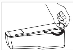
**3** Retirez le couvercle du réservoir à l'aide de la languette située à l'arrière.
