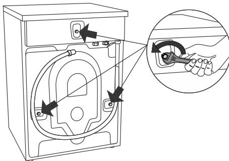
Desserrer et retirer les vis à l'aide d'une clé de 15 ou 17 (selon le modèle), comme illustré sur les images.
