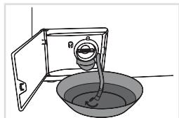
**3** Avant de nettoyer le filtre, placez l'extrémité du tube de vidange au-dessus d'une cuvette, enlevez le bouchon qui est sur le tube et laissez l'eau s'écouler.
