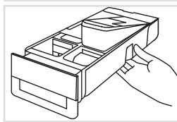
**2** Sur la partie inférieure du récipient doseur, enfoncez l'ouverture du compartiment gauche et droit du système ADS pour retirer le compartiment du récipient doseur.
