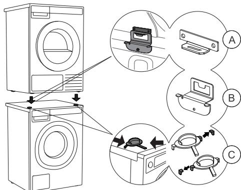
Pour superposer un sèche-linge sur un lave-linge, utilisez les pieds avant amovibles (repose-pieds en plastique (C)) et la protection anti-basculement (A+B), inclus dans le tambour du sèche-linge.
