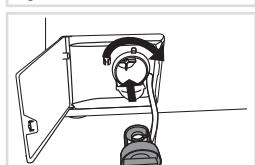
**7** Remettez le filtre en place comme indiqué sur la figure, en le tournant dans le sens des aiguilles d'une montre. Pour assurer l'étanchéité, la surface du joint doit être exempte de souillures.
