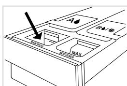
Lors d'un programme de lavage avec système ADS désactivé, ajoutez de la lessive dans le compartiment de dosage manuel.
