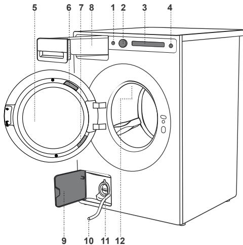
1. Interrupteur principal pour la mise Marche/Arrêt (On/Off)
