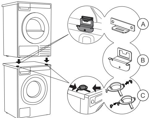
Per impilare l'asciugatrice sopra la lavatrice, utilizzare i piedini anteriori (poggiapiedi in plastica (C)) e la staffa antiribaltamento (A+B), forniti nel cestello dell'asciugatrice.
