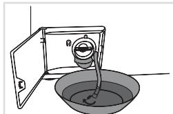
**3** Prima di pulire il filtro, far scaricare l'acqua dalla lavatrice mettendo il tubo di scarico dell'acqua in un contenitore grande ma basso, poi aprire il coperchietto sul tubo di scarico dell'acqua.
