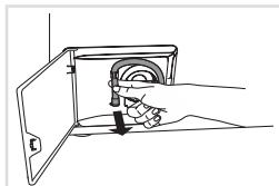
**2** Staccare dal suo ancoraggio il tubo di scarico dell'acqua.
