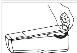
**3** Rimuovere il coperchio del serbatoio utilizzando la linguetta sul lato posteriore.
