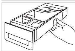
**2** Sul lato inferiore del contenitore di dosaggio, spingere nell'apertura del vano sinistro e destro dello scomparto ADS per rimuovere il serbatoio dal contenitore di dosaggio.
