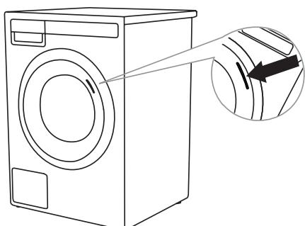
Lo sportello della lavatrice è progettato per aprirsi sul lato destro, con un indicatore visivo a forma di adesivo posto sulla parte anteriore dello sportello, che indica chiaramente il punto per la presa e l'apertura.
