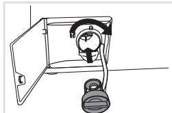
**7** Reinserire il filtro come mostrato nella figura e serrare in senso orario. Per garantire una buona tenuta, la superficie della guarnizione deve essere pulita.
