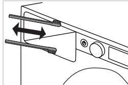
**7** Con uno spazzolino pulire anche gli ugelli sul lato superiore dell'alloggiamento del cassetto di dosaggio.
