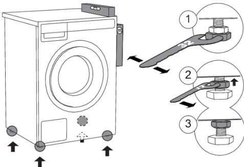
1 Livellare la lavatrice in senso longitudinale e trasversale ruotando i piedini (utilizzando una chiave inglese n. 32).
