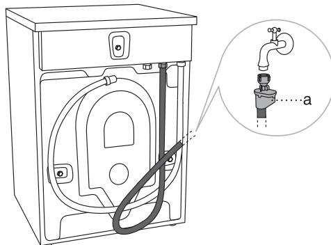
Collegare l'apparecchiatura al tubo di condutture in dotazione. La pressione dell'acqua deve essere 0,1-1 MPa (circa 1-10 kp/cm<sup>2</sup>, 1-10 BAR, 10-100 N/cm<sup>2</sup>).
