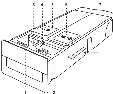
1. Scomparto per detersivo liquido di lavaggio principale e detersivo in polvere con la scritta »MainWash«
