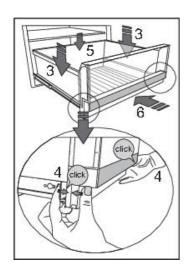
Pour insérer le tiroir dans les rails, tirez les deux rails jusqu'à la butée. Placez le tiroir sur les rails (3). Exercez une pression sur le tiroir et le rail, l'un contre l'autre, sur le devant à droite et à gauche jusqu'à ce que vous entendiez un « clic » (4). Exercez une pression sur l'arrière du tiroir au besoin (5). Pour finir, faites glisser le tiroir sur les rails afin de l'introduire à l'intérieur de l'appareil (6).
