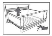
Les tiroirs sont montés sur des rails télescopiques entièrement extensibles et sont équipés d'un système de fermeture en douceur SoftClose.
