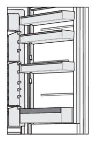
La hauteur des balconnets de porte est réglable. Soulevez le balconnet pour le sortir de la rainure et placez-le à la position souhaitée. Chaque balconnet peut supporter une charge maximale de 5 kg. Le balconnet situé en bas de la porte est adapté pour les bouteilles.
