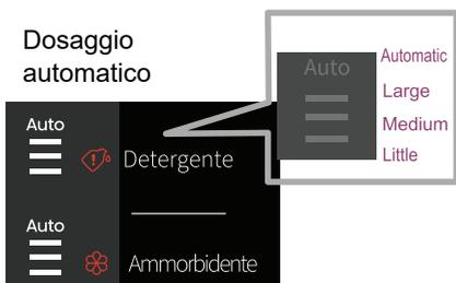
Se l'icona Auto è ACCESA e tutte e 3 le righe sono ACCESE, significa che è selezionata la funzione di dosaggio automatico. Il detergente per tessuti viene dosato automaticamente, a seconda della biancheria presente nel cestello.
