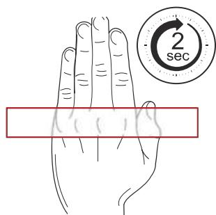
Aby wyłączyć okap lub zmienić tryb prędkości na niższy, należy przeciągnąć dłoń od strony prawej do lewej.
