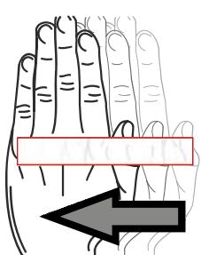
Aby włączyć okap należy przeciągnąć poziomo od strony lewej do prawej. Analogicznie użytkownik zmienia tryb prędkości na wyższy. Uwaga! Bieg 4. pełni funkcję Boost, co oznacza, że po 5 min. działania okap automatycznie powróci do biegu 3.
