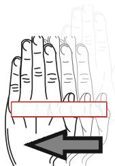
– Um die Dunstabzugshaube einzuschalten, ziehen Sie die Hand horizontal von links nach rechts. Analog wird der Geschwindigkeitsmodus in einen höheren Gang vom Benutzer gewechselt.
