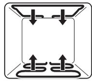
Die Beheizung erfolgt durch die oberen und unteren Heizkörper.
