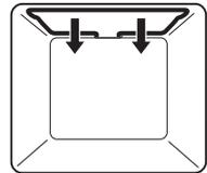
Die Beheizung erfolgt durch den oberen Heizkörper.
