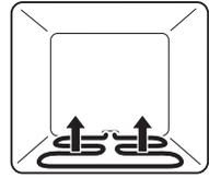
Die Beheizung erfolgt durch den unteren Heizkörper.
