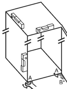
▶ Danach Tür abstützen: Stellfuß mit Gabelschlüssel SW10 am Lagerbock (B) herausdrehen, bis er auf dem Boden aufliegt, dann 90° weiter drehen.
