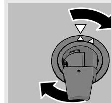
Sind die Filter nicht korrekt eingesetzt, kann dies das Spülergebnis beeinträchtigen. Hinweis: Der Geschirrspüler darf nicht ohne eingesetzte Filter verwendet werden!
