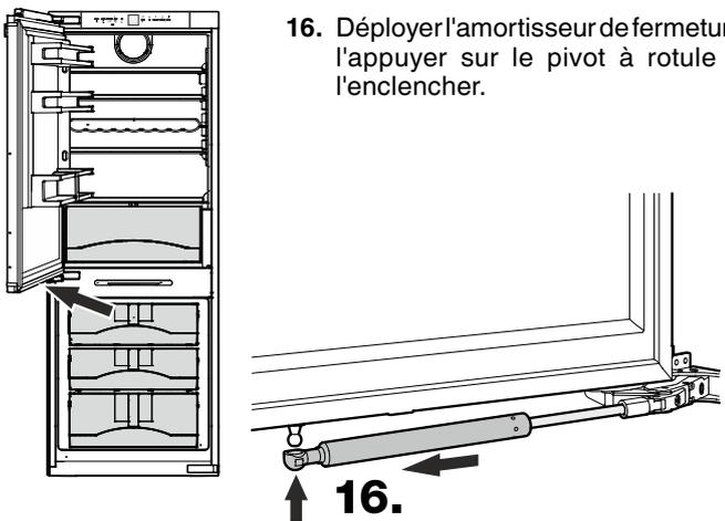
16. Déployer l'amortisseur de fermeture, l'appuyer sur le pivot à rotule et l'enclencher.
