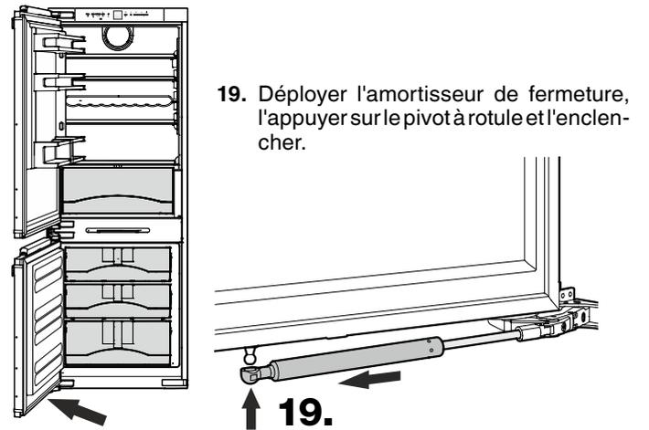
19. Déployer l'amortisseur de fermeture, l'appuyer sur le pivot à rotule et l'enclencher.
