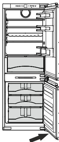
**34.** Déployer l'amortisseur de fermeture, l'appuyer sur le pivot à rotule et l'enclencher.
