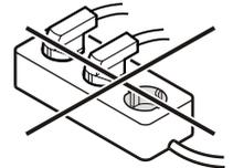
Ne pas utiliser d'onduleurs (conversion du courant continu en courant alternatif ou triphasé) ou de fiches économie d'énergie. Risque d'endommagement du système électronique!
