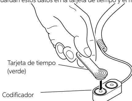
Conecte la tarjeta de tiempo (verde) a uno de los dos puertos del codificador y haga clic en el botón Write en el panel del usuario.
