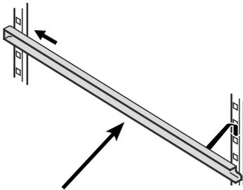
Schienen in gewünschter Höhe zuerst in hinterer Rastenleiste einschieben und dann vorne einhängen.
