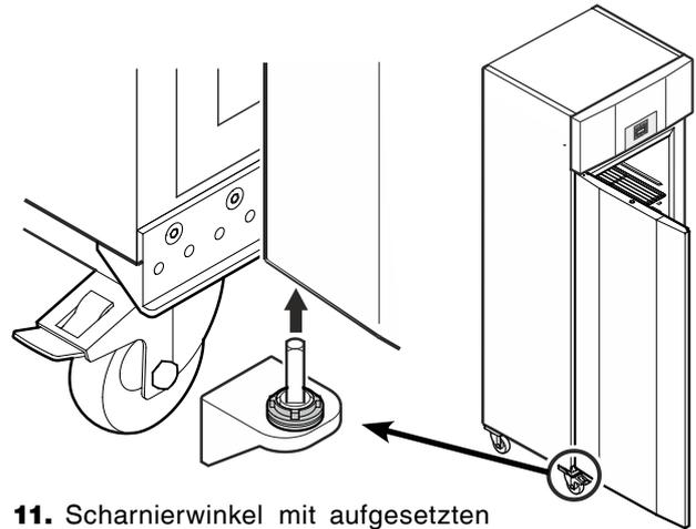
11. Scharnierwinkel mit aufgesetzten Lagerteilen in das untere Türlager einsetzen.
