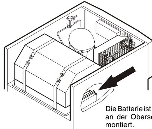
Die Batterie ist im Aggregatraum an der Oberseite des Gerätes montiert.
