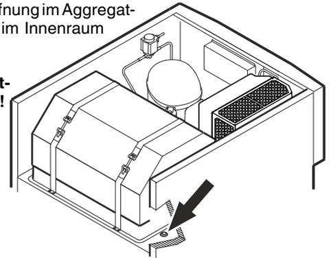
2. Schraube an der Unterseite der Frontblende herausdrehen. Frontblende hochklappen.
