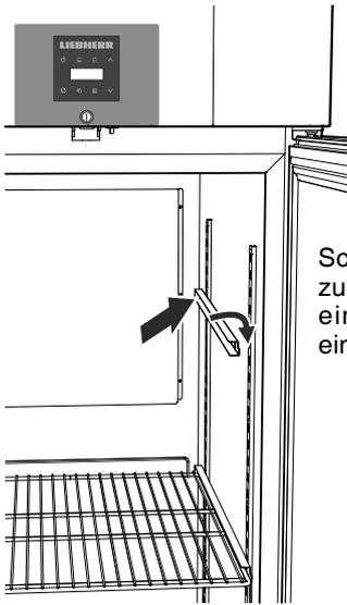
Schienen in gewünschter Höhe zuerst in hinterer Rastenleiste einschieben und dann vorne einhängen.
