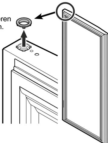
4. Lagerteile vom Scharnierwinkel abziehen.
