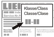
Die Klimaklasse ist auf dem Typenschild aufgedruckt.
