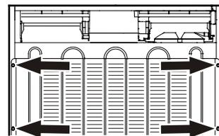
1. Schrauben (6 Stk.) des Verflüssigers herausschrauben und Verflüssiger schräg nach hinten klappen.
