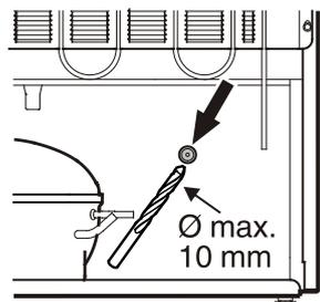
1. Markierte Stelle an der Rückseite des Gerätes aufbohren.
