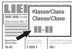
Die Klimaklasse ist auf dem Typenschild aufgedruckt.
