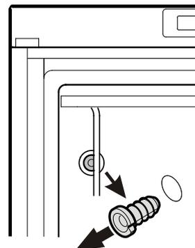
4. Fühler durch die Öffnung führen und Fühlerkabel mit Zugentlastung sichern.
