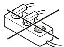
Keine Inselwechselrichter (Umwandeln von Gleichstrom in Wechsel- bzw. Drehstrom) oder Energiesparstecker verwenden. Beschädigungsfahrer für die Elektronik!
