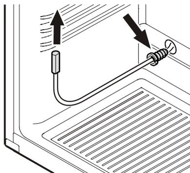
3. Fühler durch die Öffnung führen und Fühlerkabel mit Zugentlastung sichern.
