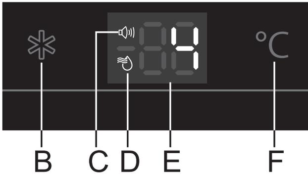
Schalten Sie die Funktion Intensivkühlen ein, indem Sie die Taste **B** so oft drücken, bis das Symbol **D** aufleuchtet.
