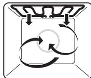
Le chauffage est effectué par le corps de chauffe du gril. L'air de l'espace de cuisson est soufflé uniformément par le ventilateur d'air chaud.
