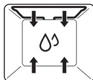
Le chauffage est effectué par les corps de chauffe supérieur et inférieur. L'humidité qui se dégage des aliments est conservée dans l'espace de cuisson. L'aliment à cuire sèche moins.
