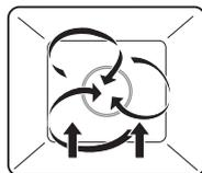
Le chauffage est effectué par de l'air chaud et la chaleur de sole. Le fond de l'aliment est soumis à une cuisson intense.
