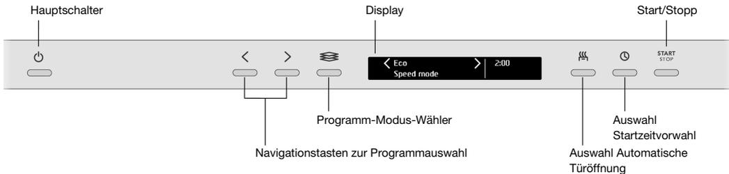
Installieren Sie den Geschirrspüler, siehe Kapitel Installation. Öffnen Sie anschließend die Tür und halten Sie den Hauptschalter gedrückt, um das Gerät einzuschalten.
