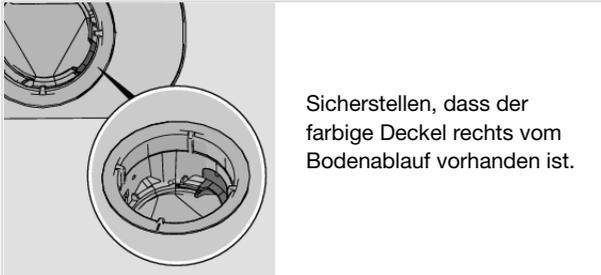
Sicherstellen, dass der farbige Deckel rechts vom Bodenablauf vorhanden ist.
