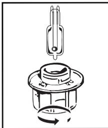
Sie können die defekte Lampe selbst austauschen. Drehen Sie die Glasabdeckung heraus und entfernen Sie dann die Lampe (das Tragen eines Gummihandschuhs erleichtert die Demontage). Bauen Sie die neue Lampe ein und setzen Sie die Glasabdeckung wieder ein.
