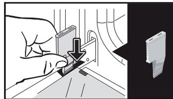
Entfernen Sie die erste mit Clip befestigte Scheibe:
