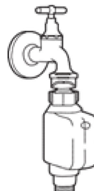
Tuyau d'arrivée d'eau sécurisé
